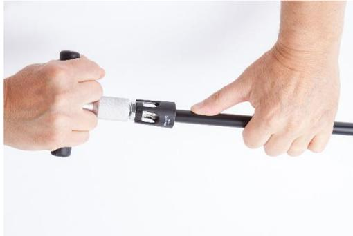
5. Vissez le raccord adaptateur UFLEX sur la vanne de l'unité de climatisation (évaporateur / compresseur). L'utilisation d'un joint cuivre approprié ainsi que d'un frein filet (Loctite 242 ou Loctite 243) est recommandée.
