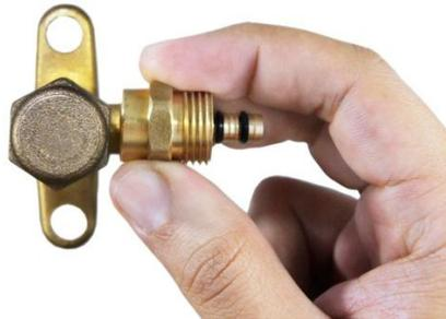
6. Serrez l'adaptateur UFLEX à l'aide d'une clé dynamométrique, en respectant les couples de serrage recommandés<sup>3</sup>.
