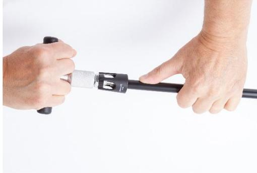
5. Vissez le corps du raccord dans l'évaporateur ou le condenseur du système de climatisation. Ne pas oublier le frein-filet.
