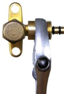
7. Schieben Sie das Rohrende mit der Überwurfmutter und dem Klemmring auf den Stützkörper des UFLEX® Adapter. Achten Sie darauf, dass Sie die O-Ringe nicht beschädigen.
