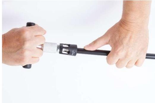
5. Schrauben Sie den UFLEX® Adapter Fitting auf das Geräte-Ventil der Klimaanlage (Verdampfer / Kompressor). Dabei empfehlen wir die Verwendung einer entsprechenden Kupferdichtung und Schraubensicherungslack (Loctite 242 oder Loctite 243).
