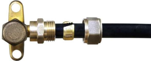
8. Schrauben Sie die Überwurfmutter von Hand an und verwenden Sie auch hier einen Drehmomenten Schlüssel, um die Überwurfmutter mit dem empfohlenen Drehmoment anzuziehen<sup>3</sup>. Denken Sie daran, den Übergang dabei gegenzuhalten. Es wird empfohlen den Überwurf mit einem Schraubensicherungslack zu fixieren. (Loctite 242 oder Loctite 243)
